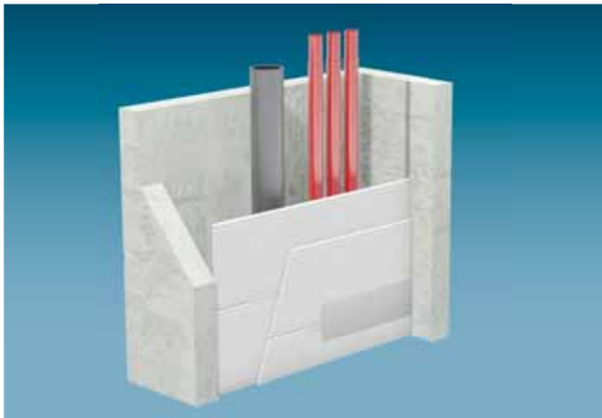
W628B.bg Кнауф шахтова стена от единичен щендер с единичен профил
